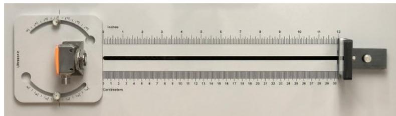
**Pack de sensores:** Cada uno de los sensores está montado en un panel extraíble que puede instalarse y soltarse rápidamente mediante tornillos. Al aflojar los tornillos se puede retirar y/o ajustar el ángulo. Cada panel de sensores se identifica claramente con las medidas angulares que pueden utilizarse para detectar el ángulo de detección mínimo y máximo de cada sensor. El sistema base incluye los siguientes tipos de sensores
