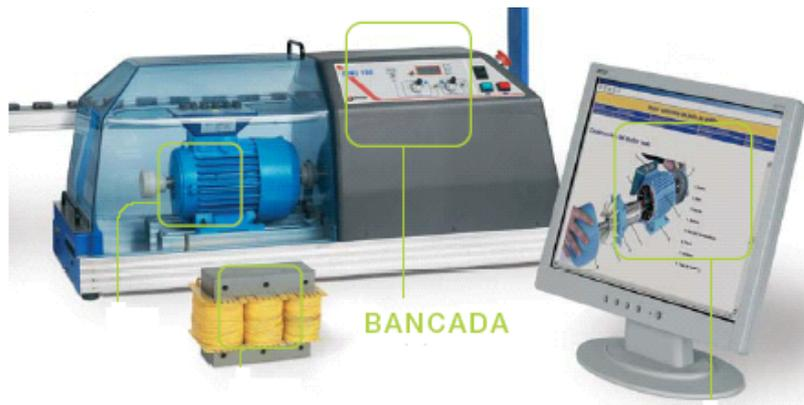
La bancada absorbe energía de la red de alimentación monofásica cuando funciona como motor de arrastre y devuelve energía a la red cuando funciona como freno. Las características técnicas de la bancada BNC-199.
