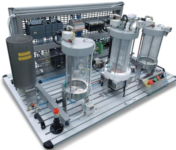
El módulo se entrega totalmente ensamblado sobre una base de perfil de aluminio extrusionado de dimensiones 1200x762x25 mm de sobremesa. Dicho perfil de aluminio dispone de ranuras de 8,5 mm que permiten el montaje de componentes sobre la base y de cuatro asas para facilitar el traslado de una ubicación a otra. Sobre dicha base se disponen los siguientes bloques funcionales:
