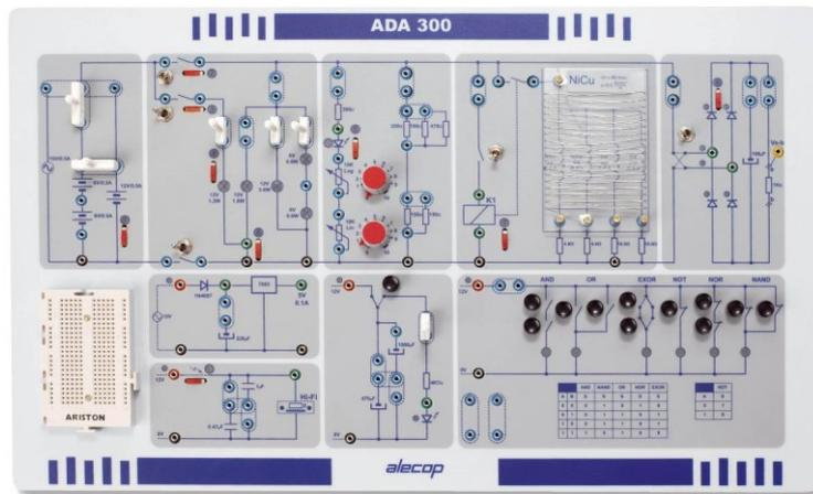
Se pueden ampliar las actividades de la aplicación ya que se cuenta con una placa de montaje de circuitos complementarios. Esta placa permite interconectar elementos eléctrico/electrónicos (resistencias, condensadores, diodos etc.) de una manera rápida y sencilla sin la necesidad de soldar los componentes, posibilitando la reutilización de los componentes para hacer varios montajes.
