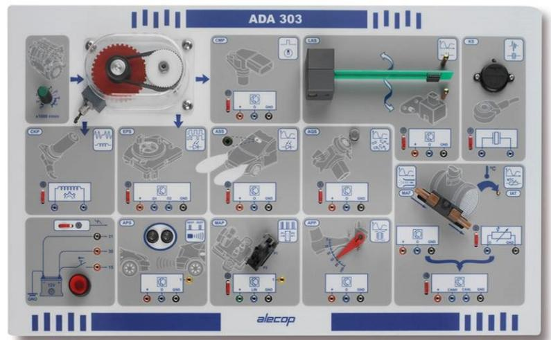
Además del funcionamiento autónomo del equipo varios de los sensores de la aplicación se pueden conectar con la unidad de control UCE, panel ADA304, para poder analizar el funcionamiento del sistema de inyección conectando al mismo sensores "reales".
