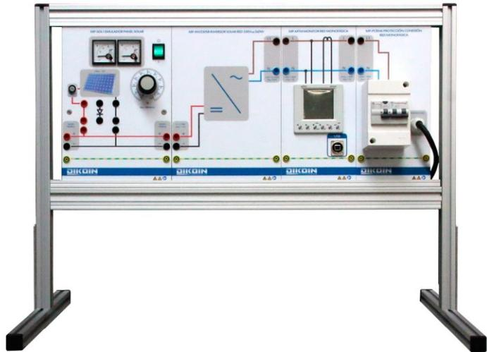
El sistema está provisto de elementos de medida de las variables necesarias para analizar el comportamiento de la instalación.
