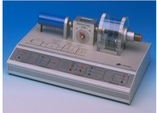
En el panel frontal de la maqueta están situadas las bornas de conexión entre los distintos captadores y motor con el mueble bastidor de sobremesa. El armario modular de control consta de una serie de módulos, con unas misiones específicas:
