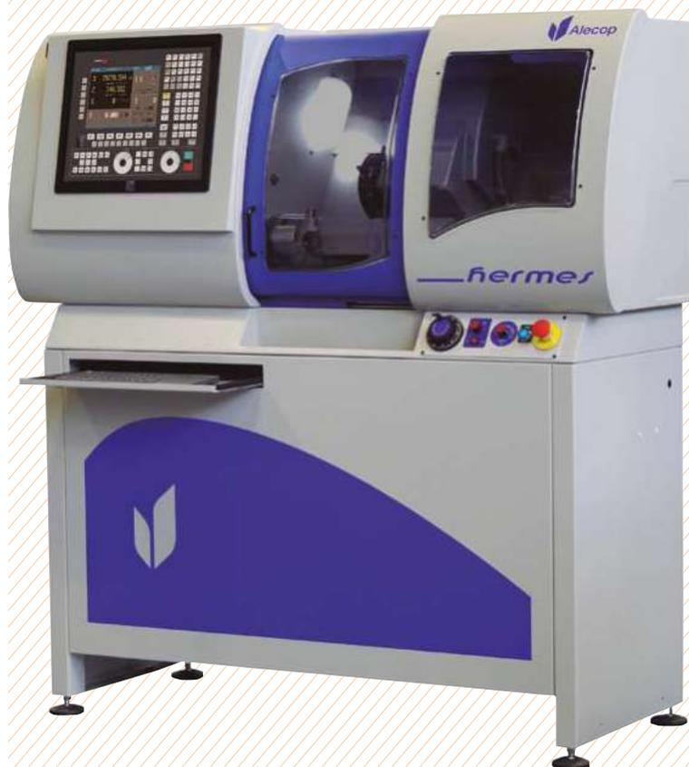
**Multi CNC.** Programación y visualización de simuladores FAGOR, SIEMENS y FANUC. PC, pantalla táctil y teclado incorporados.
