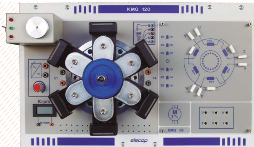
Kits de construcción rápida y pruebas de máquinas eléctricas a baja tensión.
